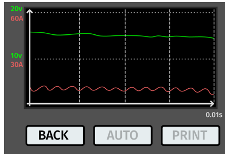
Figura 12. Visualización gráfica de la tensión medida y corriente del alternador sometido a prueba
