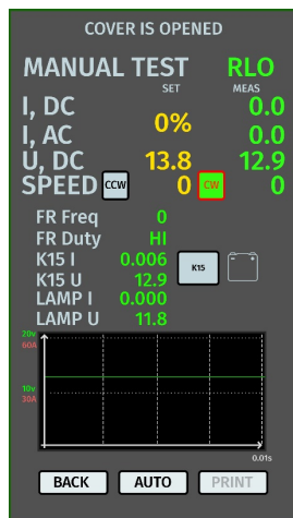
Рисунок 9. Меню режиму перевірки генератора типу P/D і R
