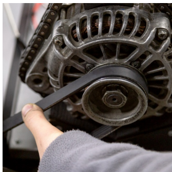
Рисунок 17. Проверка натяжения ремня генератора
