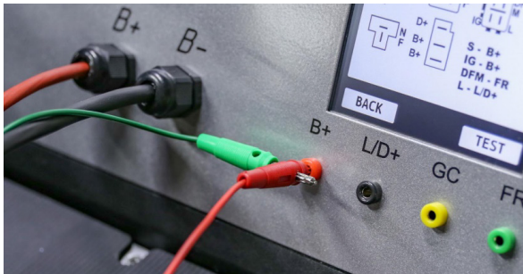
Рисунок 24. Підключення двох дротів до діагностичного виводу стенда
