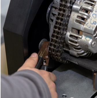
Рисунок 18. Підключення силових кабелів до генератора
