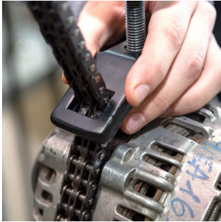
Figura 15. Fijación del alternador
