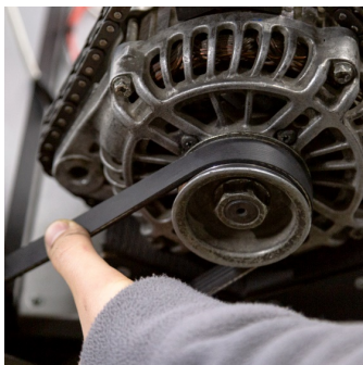
Рисунок 17. Перевірка натягу ремня генератора
