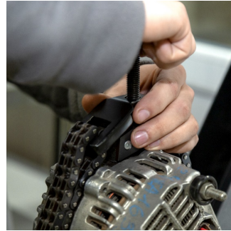
Figura 15. Fijación del alternador
