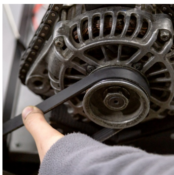
Rysunek 17. Badanie napięcia pasa alternatora
