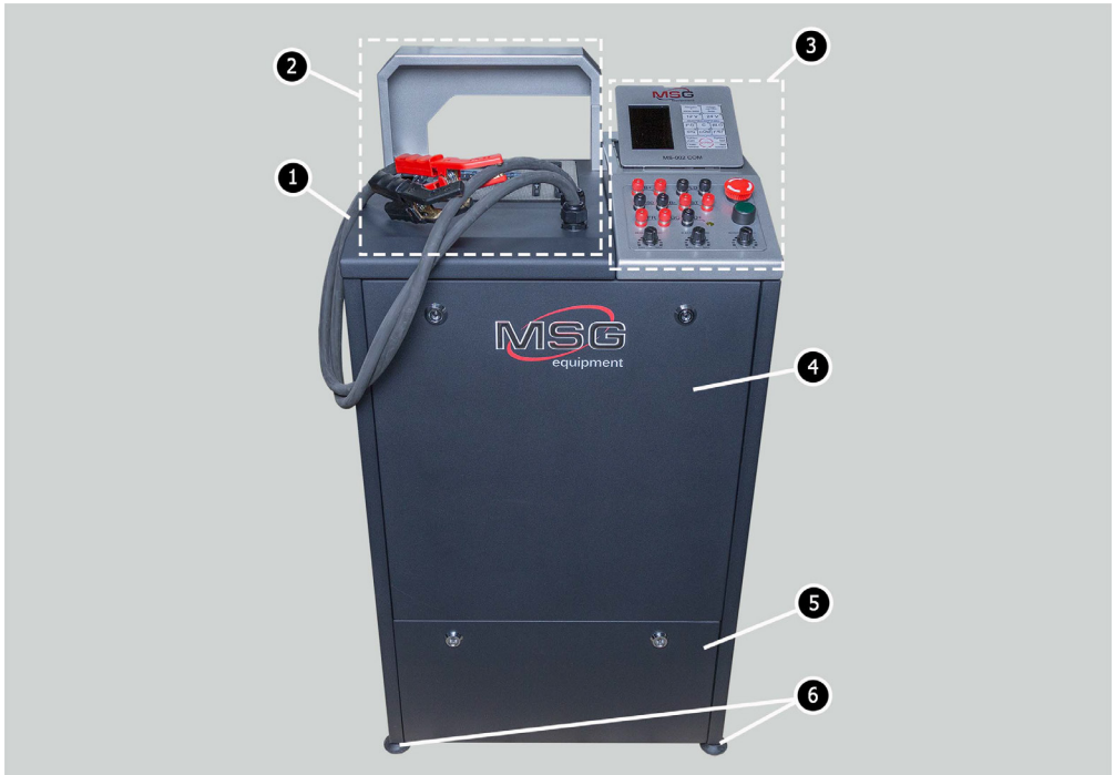
Figura 1. Elementos básicos del banco de pruebas
