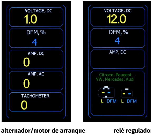
Figura 4. Pantalla del banco de pruebas durante el diagnóstico del alternador/relé regulador del tipo Lamp o arrancador
