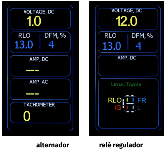
Figura 8. Pantalla del banco de pruebas durante el diagnóstico del alternador/relé regulador del tipo RLO
