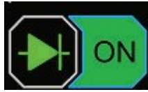
Рисунок 4. Відображення символу діода на екрані тестера
