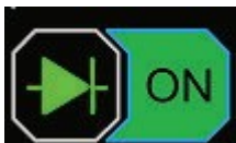
Rysunek 4. Wyświetlanie symbolu diody na ekranie testera
