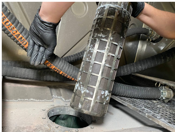
Рисунок 46. Демонтированный фильтр бака
