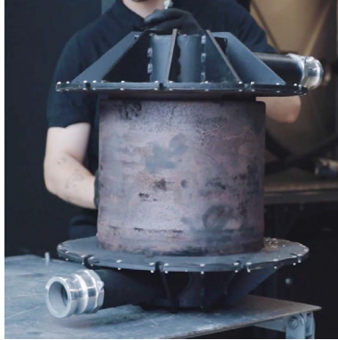
Рисунок 29. Монтаж фітинга на фільтрі
