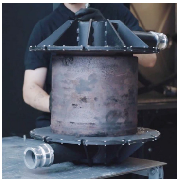
Figura 29. Montaje del conector en el filtro
