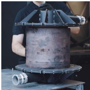
Rysunek 29. Montaż złączki na filtrze
