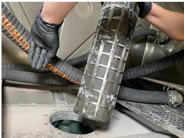
Rysunek 46. Zdemontowany filtr zbiornika
