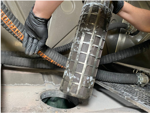
Рисунок 46. Демонтований фільтр бака
