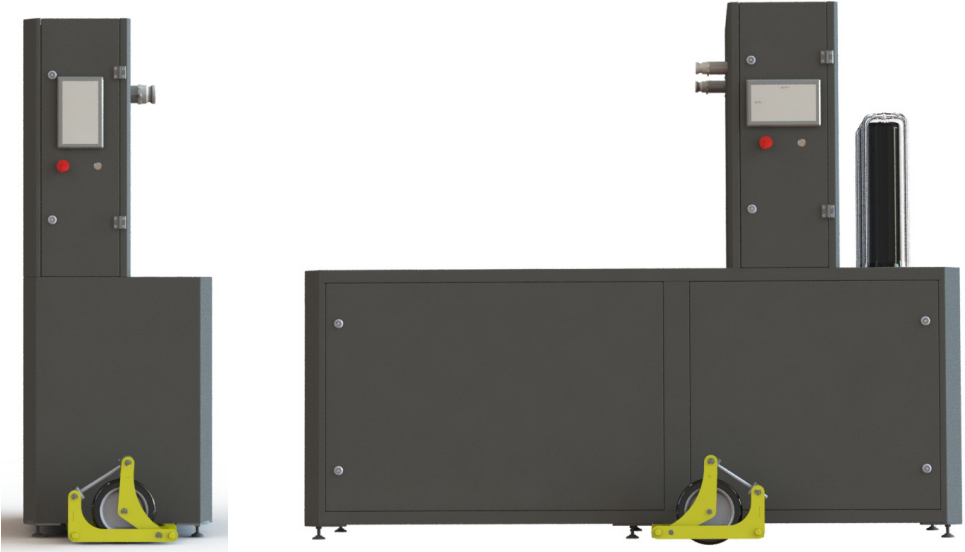
Рисунок 2. Місце встановлення такелажного візка під модулями MS900A і MS900B
