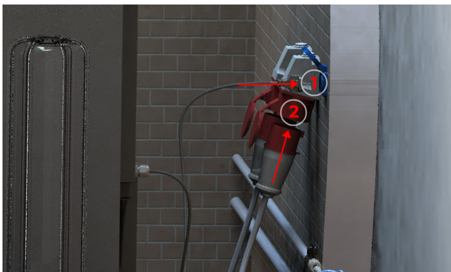
Figura 23. Conexión de la alimentación eléctrica de la máquina
