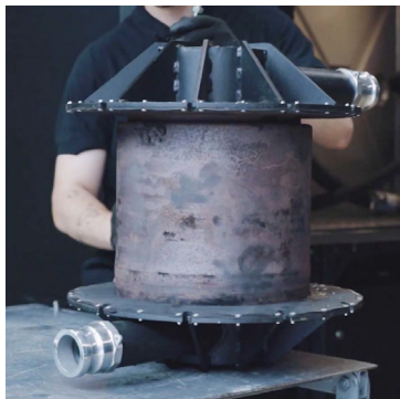
Рисунок 29. Монтаж фитинга на фильтре
