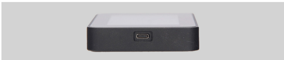
Rysunek 3. Złącze USB Type-C
