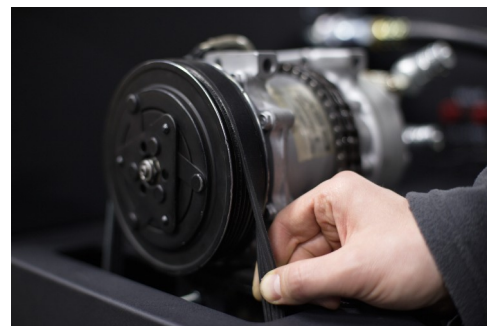
Рисунок 24. Встановлення ремня і перевірка ступеня його натягу
