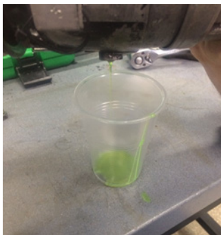
Рисунок 21. Контроль стану мастила компресора
