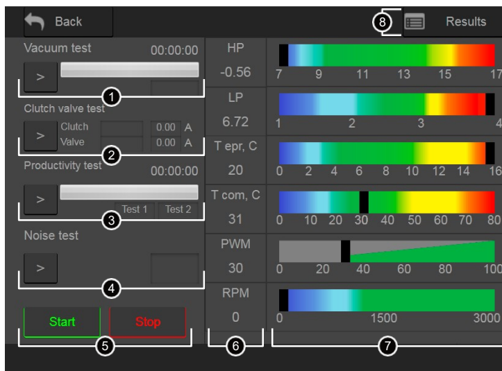
Рисунок 7. Окно автоматической диагностики компрессора
