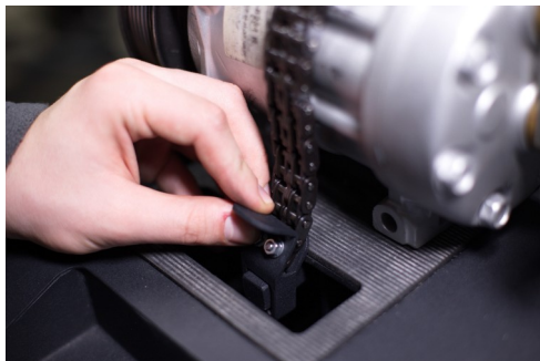
Рисунок 23. Установка компрессора на стенд и его фиксация
