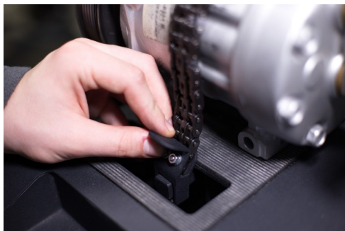
Рисунок 23. Встановлення компресора на стенд і його фіксація
