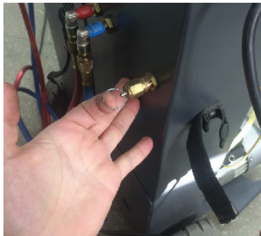
Figura 20. Válvula de descarga de la estación de carga (ejemplo)
