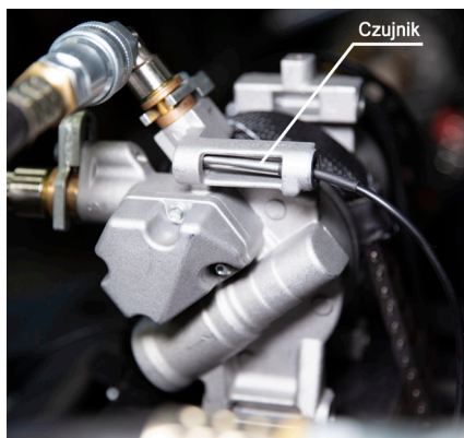
Rysunek 29. Pozycjonowanie dotykowego Czujnika temperatury
