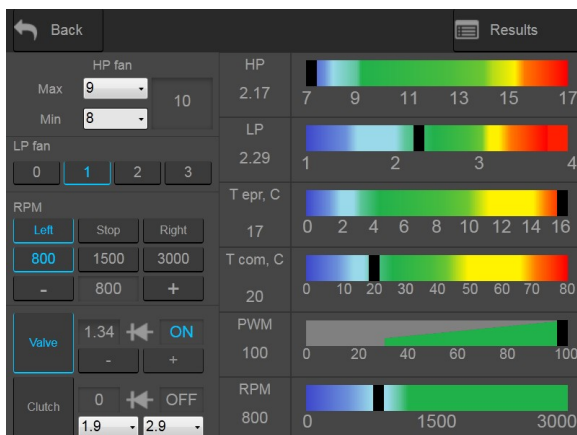
Rysunek 32. Ustawienia stanowiska podczas docierania sprężarki
