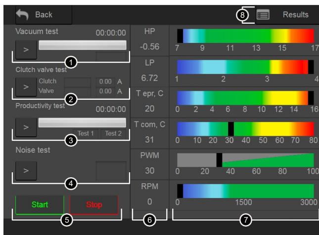
Rysunek 7. Okno automatycznej diagnostyki sprzężarki
