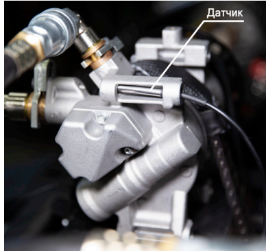
Рисунок 29. Позичонування контактного датчика температури
