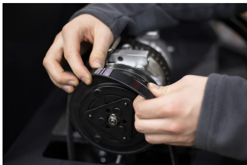
Рисунок 24. Установка ремня и проверка степени его натяжения
