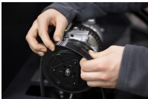
Рисунок 24. Встановлення ремня і перевірка ступеня його натягу
