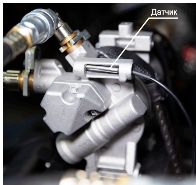
Рисунок 29. Позиционирование контактного датчика температуры
