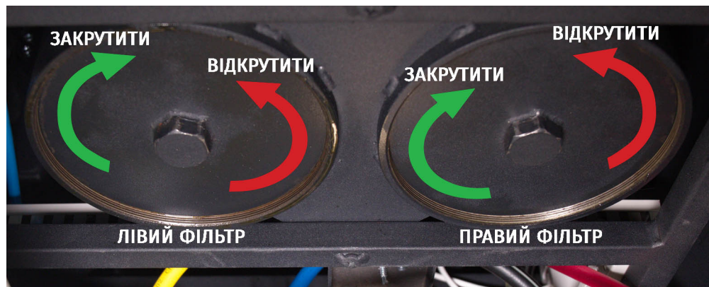
Рисунок 37. Напрямок обертання кришки під час заміни фільтрів MS0101
